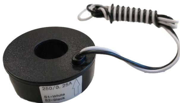
La serie de **transformadores TRC** son transformadores de corriente especialmente diseñados para instalar encima de un interruptor. Todos los modelos tienen secundario de 250 mA y son compatibles con los equipos SEM One y SEM Three RS-485 y con equipos de terceros.
