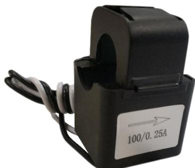
Los **transformadores TRA1 100A** son transformadores de corriente especialmente diseñados para instalar encima de un interruptor. Todos los modelos tienen secundario de 250 mA y son compatibles con los equipos SEM One y SEM Three RS-485 y con equipos de terceros.
