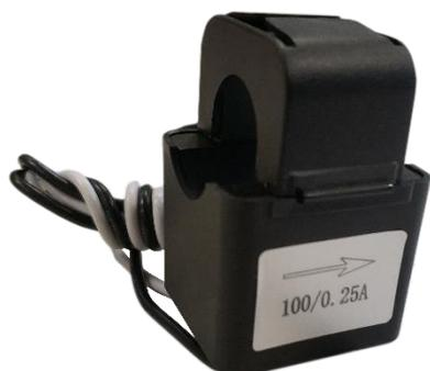
Os **transformadores TRA1 20A** são transformadores de corrente especialmente desenhados para instalação sobre um interruptor ou um disjuntor. Todos os modelos têm um secundário de 250 mA e são compatíveis com os dispositivos SEM One e SEM Three RS-485 e também com dispositivos de fabricantes terceiros.
