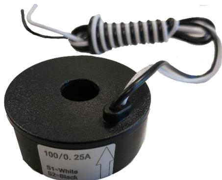
Los **transformadores TRC1 100A** son transformadores de corriente especialmente diseñados para instalar encima de un interruptor. Todos los modelos tienen secundario de 250 mA y son compatibles con los equipos SEM One y SEM Three RS-485 y con equipos de terceros.
