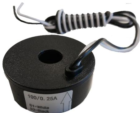
Os transformadores **TRC1 100A** são transformadores de corrente especialmente desenhados para instalação sobre um interruptor ou um disjuntor. Todos os modelos têm um secundário de 250 mA e são compatíveis com os dispositivos SEM One e SEM Three RS-485 e também com dispositivos de fabricantes terceiros.
